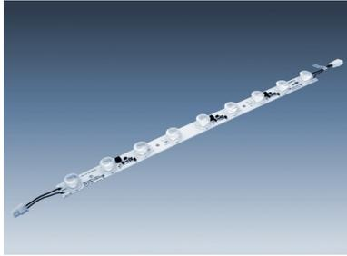
LED-Seitenlicht-Modul mit High-Power-LEDs, besonders geeignet für schlanke ein- und beidseitig beleuchtete Displays und Leuchtkästen. Spezial-Linsen ermöglichen besonders geringe Einbau-/Displaytiefen ab 40 mm (je nach zu hinterleuchtendem Material)
