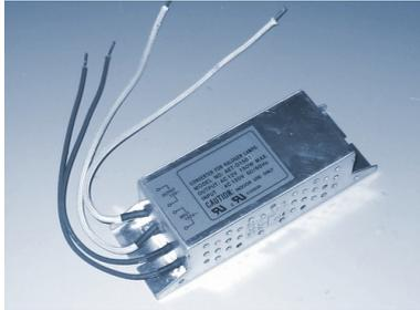
Elektronischer Transformator, für 110 V- / 120 V-Netze, gesichert gegen Übertemperatur, Überlast, Leerlauf und Kurzschluß (reversibel)
