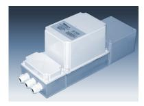
Voll vergossener Sicherheitstransformator für 12V Gleichstrom, strahlwassergeschützt (IP65), primär abgesichert
