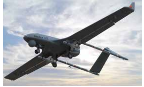
تتميز الطائرة Shadow M2 من شركة Textron Systems بإجمالي حمولة صافية تصل لغاية حتى 130 رطلاً (59 كغم) مع حمل وقود كامل.
