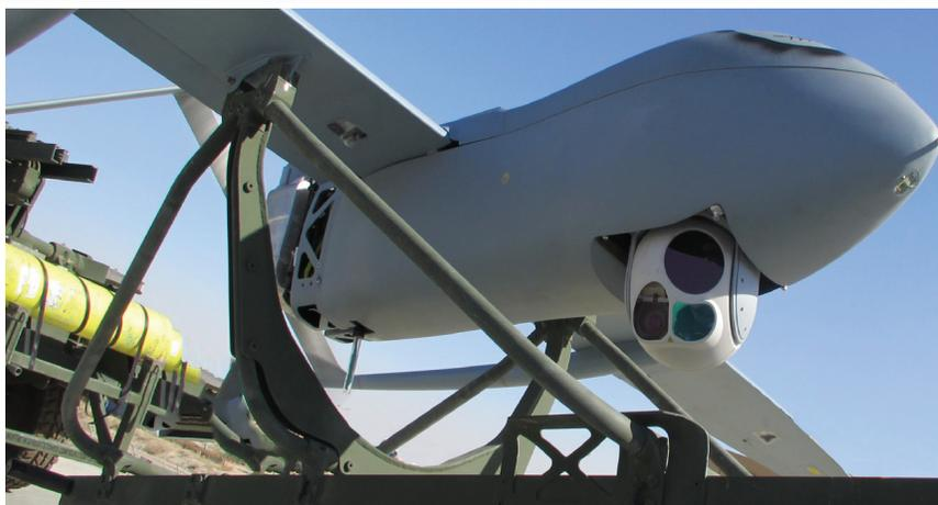
*Una aeronave Aerosonde incorpora una carga electro-óptica/infrarroja combinada y un interruptor de comunicaciones para ofrecer desempeño multimisión durante el día y la noche en un solo vuelo.*
