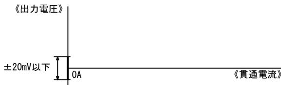
『残留電圧温度係数』 周囲温度の変化による残留電圧の変動 (残留電圧温度係数は代表値です) ±1mV/°C typ
