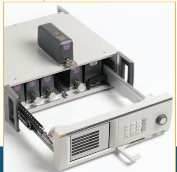
Para acessar os módulos de medição e controle, basta abrir o painel frontal. Os módulos são fáceis de substituir quando o 6270A é montado em um rack.
