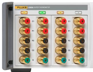
Los cinco terminales de todos los Supertermómetros están alineados en vertical, para facilitar al máximo la conexión de sondas y la identificación del canal correspondiente.
