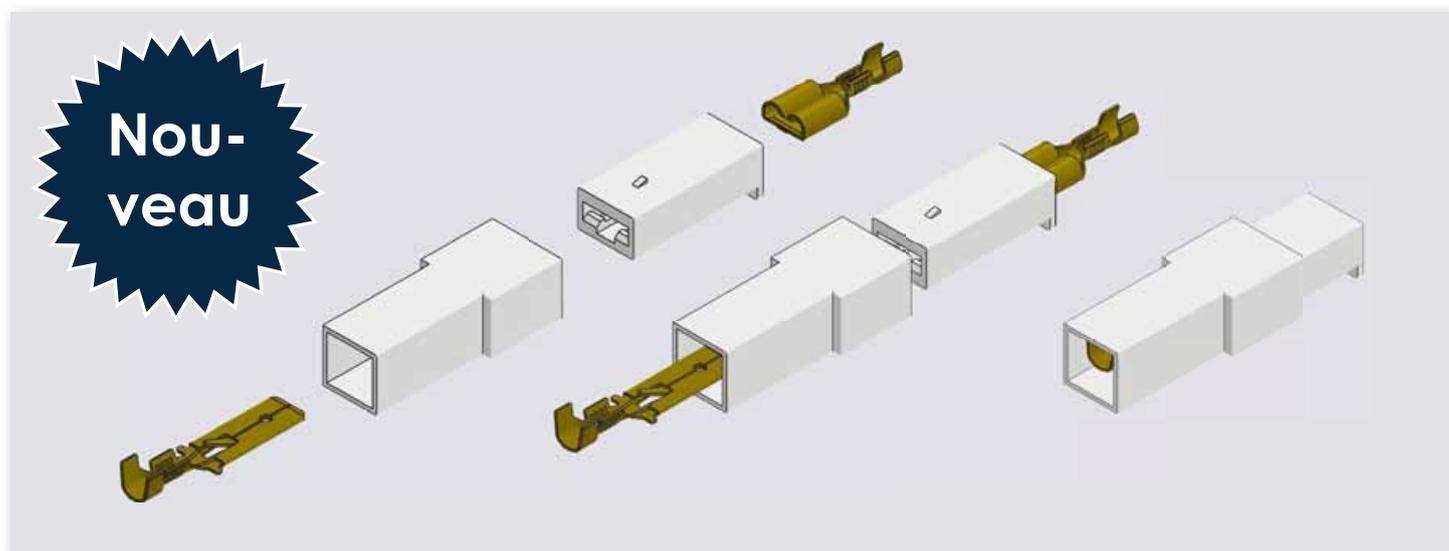
Nous proposons à présent des languettes de broches plates et des clips femelles avec languettes encliquetables et douilles correspondantes dans les tailles standard: 2,8mm, 4,8mm et 6,3mm. Les clips femelles et les languettes plates sont introduits dans les douilles
