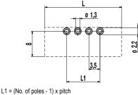
Solder paste thickness: 0,15 - 0,2 mm
