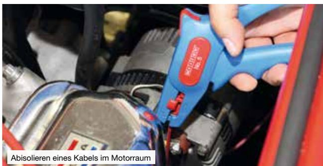
Abisolieren eines Kabels im Motorraum
