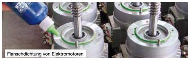
Flanschdichtung von Elektromotoren
