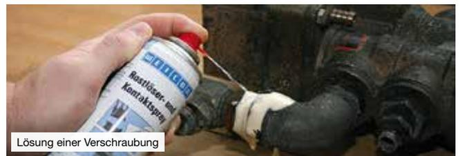
Lösung einer Verschraubung
