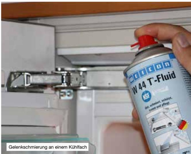
Gelenkschmierung an einem Kühlfach
