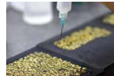
Goldelemente werden mit Contact VA 100 auf einer Trägerplatte fixiert
