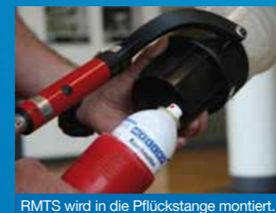
RMTS wird in die Pflückstange montiert.
