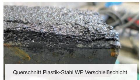
WEICON WP - Reparatur & Abriebschutz einer SAG-Mühlen-Schütte
