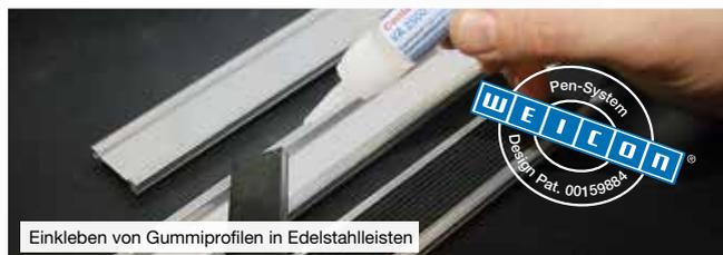
Einkleben von Gummiprofilen in Edelstahlleisten
