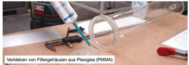
Verkleben von Filtergehäusen aus Plexiglas (PMMA)
