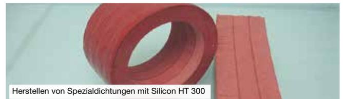
Herstellen von Spezialdichtungen mit Silicon HT 300
