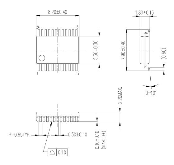
端子厚さ:0.22±0.10 (LEAD THICKNESS) カッコ内の寸法値は参考値とします。 The value parenthesized is not specified.
