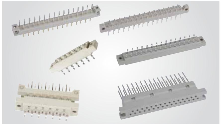
CONEC Steckverbinder nach DIN 41617 finden Einsatz in vielfältigen Anwendungsbereichen der Industrie. Das Programm umfasst Stift- und Federleisten in den Polzahlen 13, 21 und 31. Als Anschlussarten gibt es Einlöt- gerade und gewinkelt sowie Handlöt. Kontaktoberflächen sind je nach Einsatz in den Ausführungen versilbert oder vergoldet verfügbar. Im Programm gibt es ferner einen Umsetzesteckverbinder (Adapter), der von DIN 41617 auf DIN EN 60603 umstellt.
