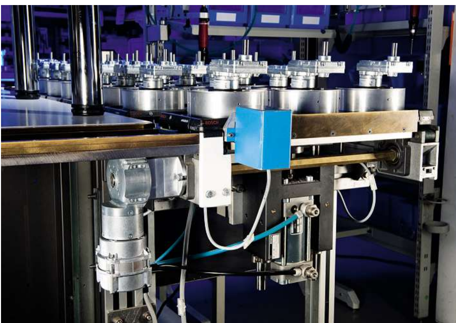
Mit einem EC-Motor und dem Eta-Crown-Winkelgetriebe wird die Transportgeschwindigkeit in Montageanlagen durch den Verarbeitungsprozess bedarfsgerecht und damit energieoptimiert gesteuert.
