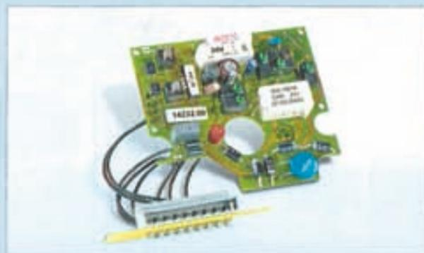
5: Die Steuerungsplatine enthält Endschalter, die die einzelnen Schaltpositionen des Antriebs markieren. Weitere Mikroschalter erfassen die Position der Schaltelemente.
