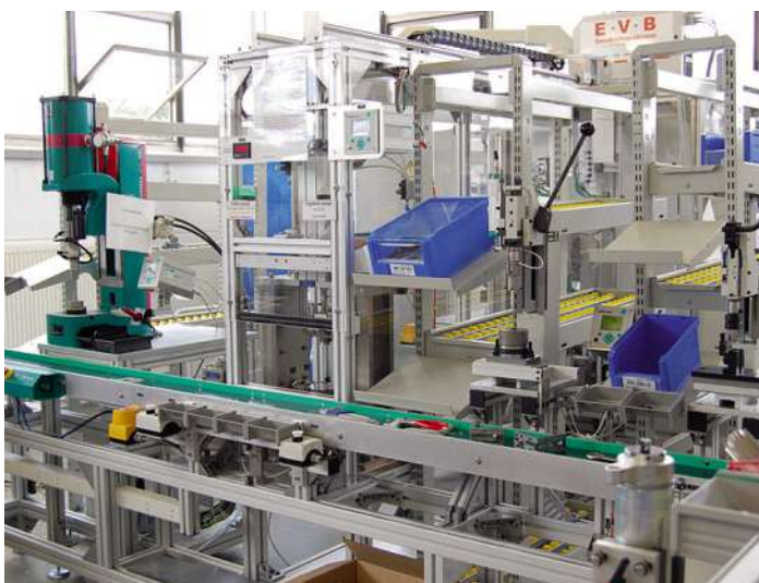
Diese hybride Montagelinie zum Zusammenbau von Etacrown-Getriebemotoren arbeitet nach dem One-Piece-Flow-Prinzip.
