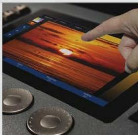
Benutzerdefinierbare UDK-Tasten können mit Funktionen wie Highlight oder Rem-Dim belegt werden. Auch Einstellungen für Blinder, Strobes, Nebelmaschinen oder Arbeitslicht sind optimal auf den UDK-Tasten ablegbar.
