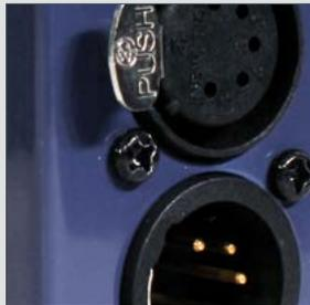
Die Ethernet-DMX-Box ist ein vorkonfigurierter Ethernet-DMX-Konverter, der mit einem Universe (512 Kanäle) in beide Richtungen als Input- oder Output-Node eingesetzt werden kann. Als Protokoll wird ArtNet verwendet.
