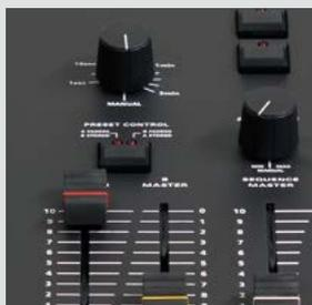
Als weiteres Highlight in dieser Kompaktklasse bietet die Juggler Konsole eine Sequenzfunktion für Lauflichter oder Speicherstapel. Bis zu 12 Sequenzen mit max. 99 Schritten lassen sich speichern und automatisch als Lauflicht oder manuell per GO-Taste wiedergeben. Die Wiedergabegeschwindigkeit einer Sequenz kann über einen Geschwindigkeitsregler eingestellt werden.
