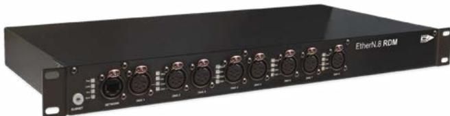
Der EtherN.8 RDM ermöglicht eine flexible Datenkonvertierung von Ethernet auf DMX/RDM. Bis zu 8 Universen wandelt der EtherN.8 RDM von ArtNet in DMX/RDM-Daten. Die selbsterklärende Konfiguration ist durch einen internen Webserver oder über eine optionale Software möglich.
