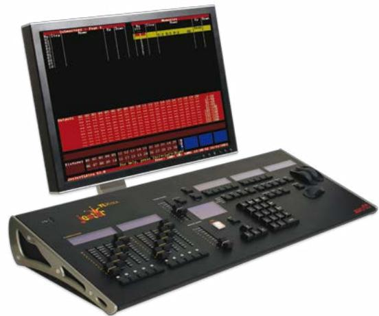
Die Jester TLXtra ist eine kompakte Hybrid-Lichtsteuerkonsole zur Kontrolle von bis zu 200 Dimmerkreisen und 30 Moving Lights. Zur theatertypischen Anwahl von Dimmerkreisen ist die TLXtra mit einem numerischen Tastenfeld (Keypad) und gebräuchlichen Syntaxbefehlen ausgestattet.
