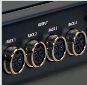
Der Demux 24 ist die perfekte Lösung für eine Ansteuerung älterer analoger Dimmersysteme. Entwickelt nach höchsten Standards, ermöglicht der Demux 24 den Einsatz moderner DMX-Lichtsteuerungen mit analoger Dimmertechnik. Die analogen Ausgänge des Demux 24 sind wahlweise für positive oder negative 0-10V Ausgangssignale ausgelegt und können den Anforderungen entsprechend angepasst werden.
