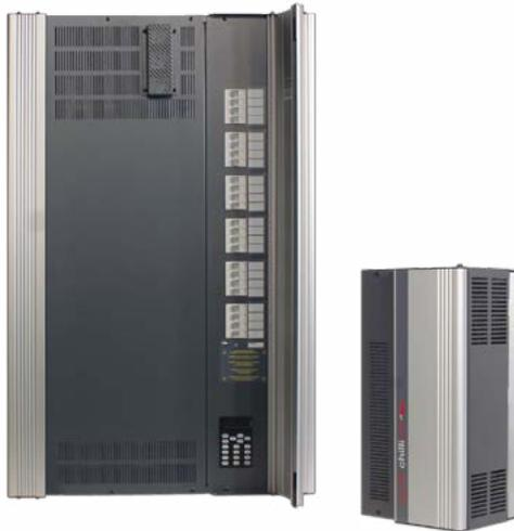
Die Versionen Chilli Pro 410i HF und 1210i HF sind spezielle Ausführungen für die 1-10V Ansteuerung von HF- oder DSI-Vorschaltgeräten. Über 4 bzw. 12 Hochlastrelais (230V/10A) werden die verwendeten Vorschaltgeräte mit Spannung versorgt. Die Ausgabe der 1-10V Ansteuerung erfolgt über eine separate Klemmleiste.
