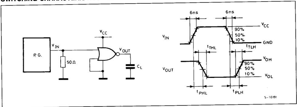
TEST CIRCUIT  $I_{CC} (Opr.)$
