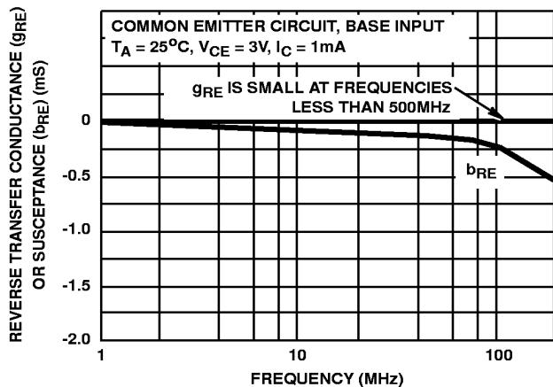
FIGURE 15. TYPICAL REVERSE TRANSFER ADMITTANCE vs FREQUENCY
