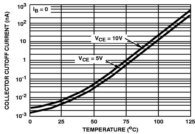
FIGURE 2. TYPICAL COLLECTOR-TO-EMITTER CUTOFF
