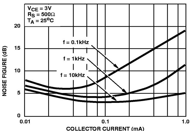
**FIGURE 8. TYPICAL NOISE FIGURE vs COLLECTOR CURRENT**
