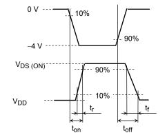
$$\begin{split} &V_{DD} = \text{-}10 \text{ V} \\ &R_G = 4.7 \text{ }\Omega \\ &\text{D.U.} \le 1\% \\ &V_{IN}\text{: }t_r, t_f < 5 \text{ ns} \end{split}$$
