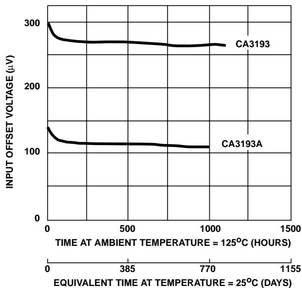
FIGURE 13. INPUT OFFSET VOLTAGE vs TIME
