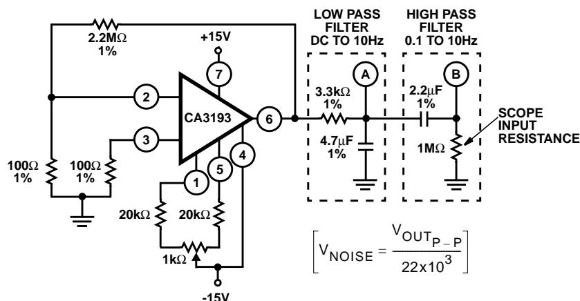
FIGURE 4A. TEST CIRCUIT - 0.1Hz TO 10Hz
