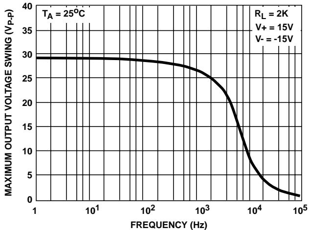
FIGURE 22. MAXIMUM UNDISTORTED OUTPUT VOLTAGE vs FREQUENCY
