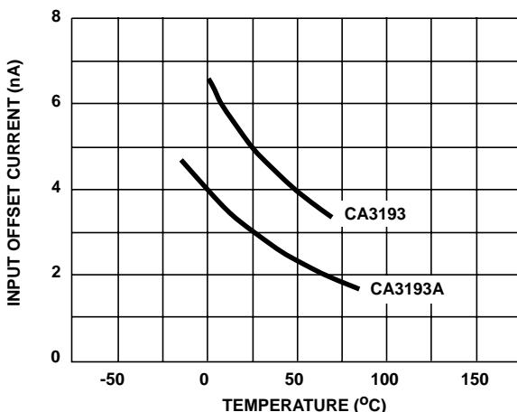
FIGURE 15. TYPICAL INPUT OFFSET CURRENT vs TEMPERATURE
