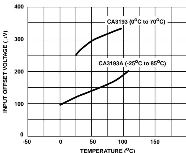
FIGURE 12. TYPICAL INPUT OFFSET VOLTAGE TEMPERATURE CHARACTERISTIC
