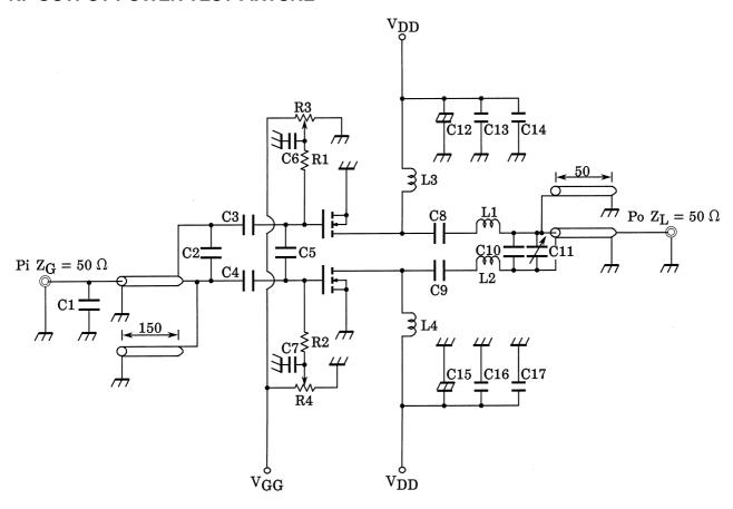
C1 : 1pF MICA CAPACITOR C2 : 33 pF  $\times$  3 (PARALLEL) MICA CAPACITOR
