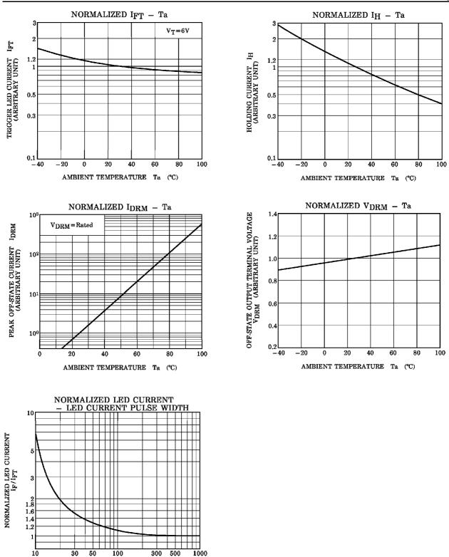
LED CURRENT PULSE WIDTH  $P_W$  ( $\mu$ s)
