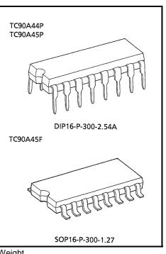
Weight DIP16-P-300-2.54A : 1.00 g (Typ.) SOP16-P-300-1.27 : 0.18 g (Typ.)
