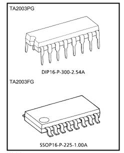
Weight DIP16-P-300-2.54A: 1.00g (typ.) SSOP16-P-225-1.00A: 0.14g (typ.)
