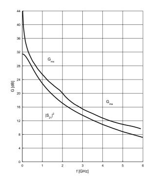
Power gain  $G_{ma}$ ,  $G_{ms} = f (V_{CE})$  $I_{C} = 20 \text{ mA}$ f = parameter in GHz
