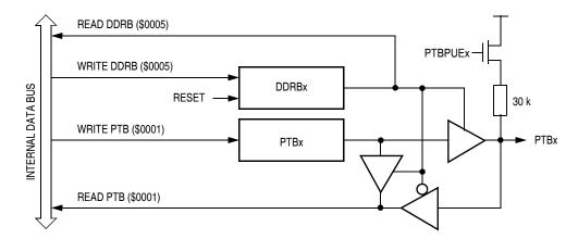
Figure 12-7. Port B I/O Circuit
