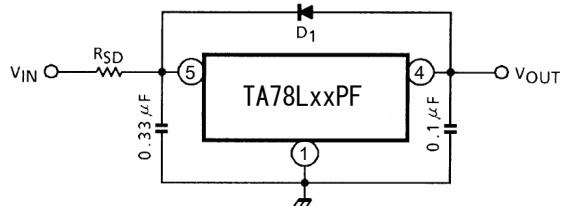
D<sub>1</sub> : IC protective diode
