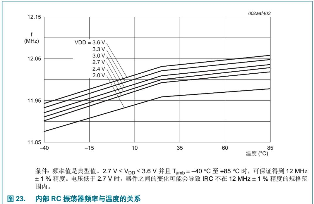
图 23. 内部 RC 振荡器频率与温度的关系
