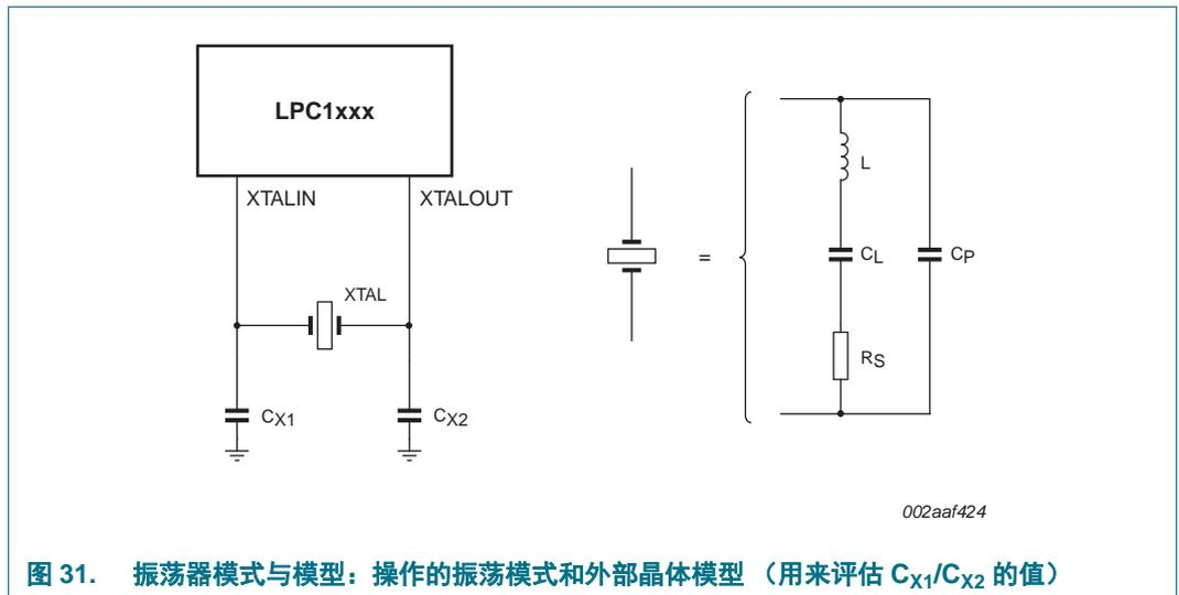
图 31. 振荡器模式与模型：操作的振荡模式和外部晶体模型（用来评估  $C_{X1}/C_{X2}$  的值）
