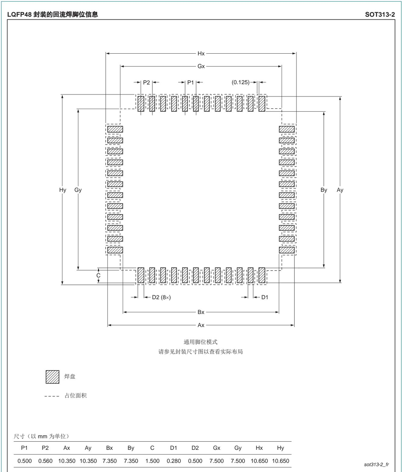
图 38. LQFP48 封装的回流焊
