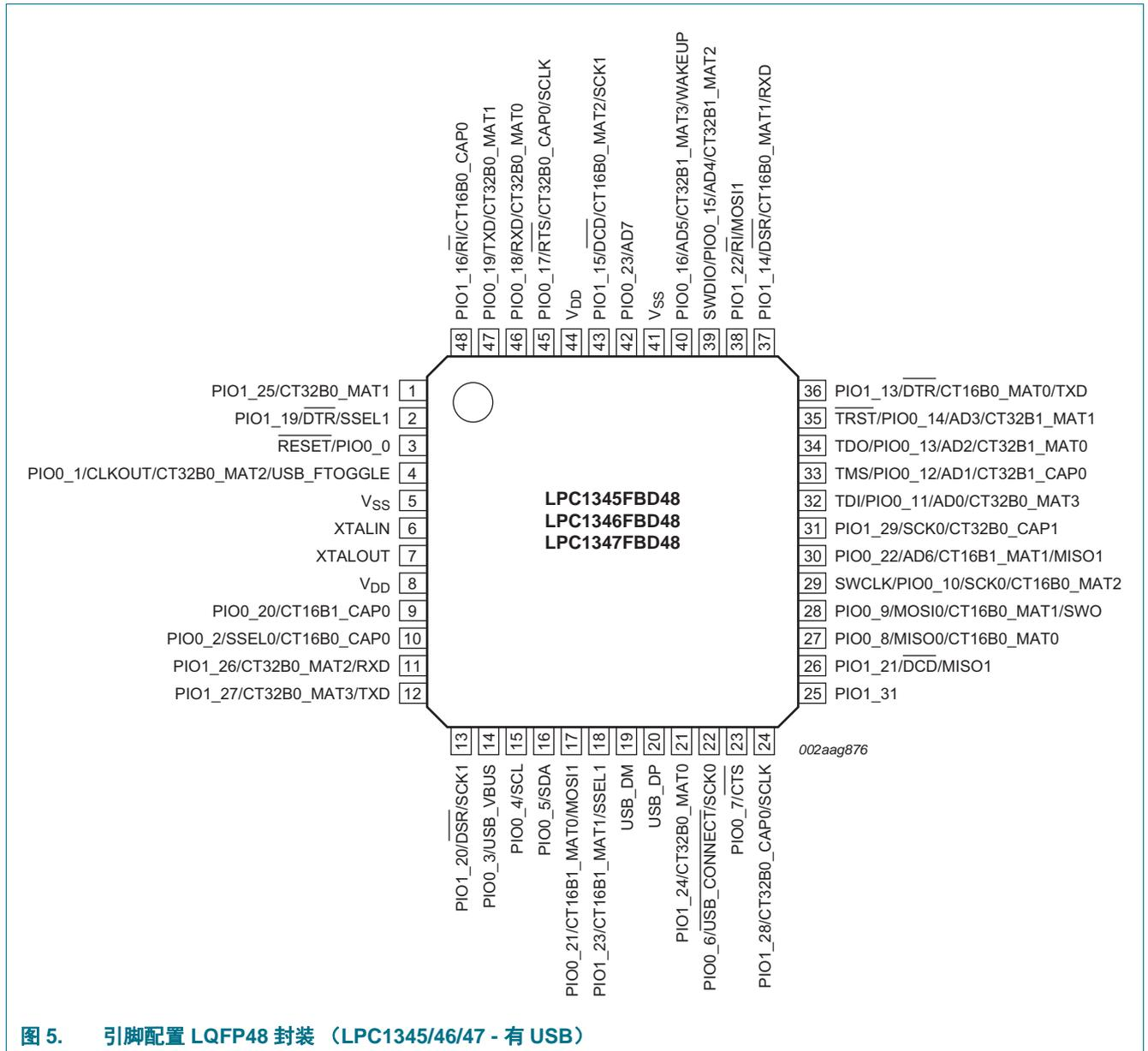
图 5. 引脚配置 LQFP48 封装 (LPC1345/46/47 - 有 USB)
