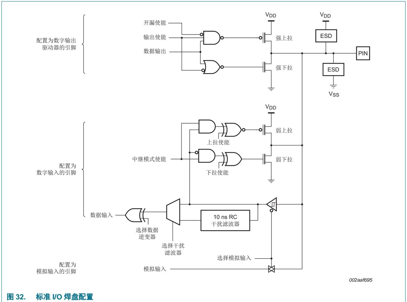
图 32. 标准 I/O 焊盘配置
