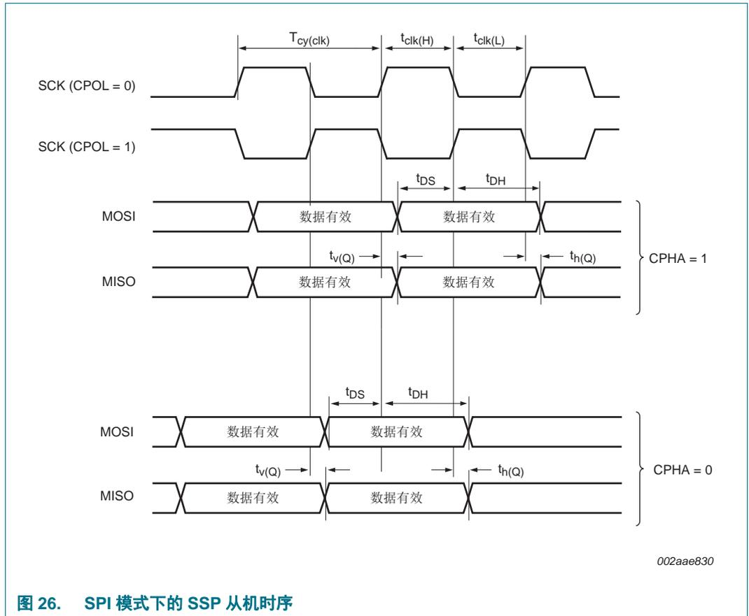
图 26. SPI 模式下的 SSP 从机时序
