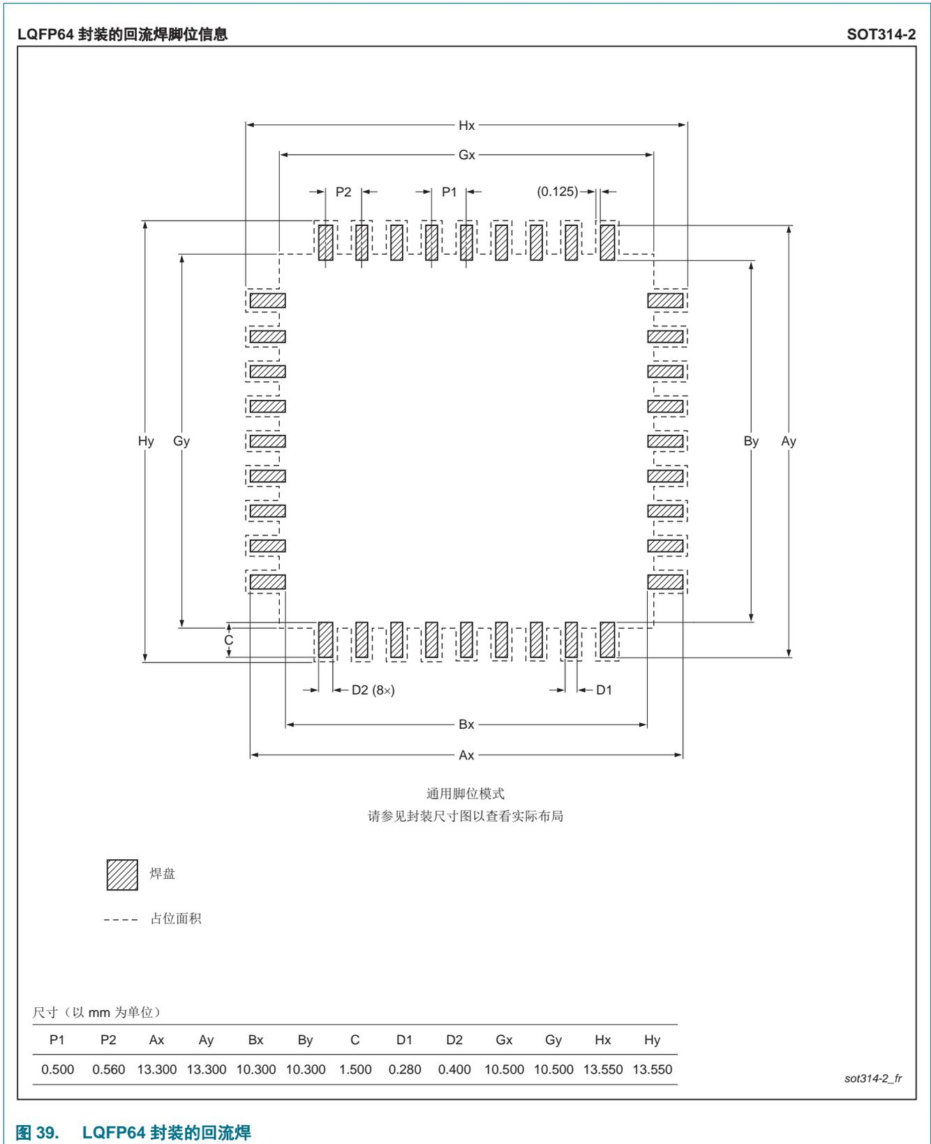
图 39. LQFP64 封装的回流焊
