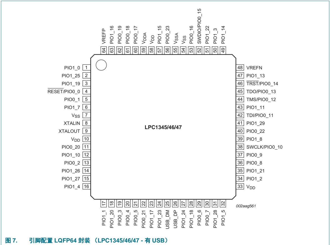
图 7. 引脚配置 LQFP64 封装 (LPC1345/46/47 - 有 USB)
