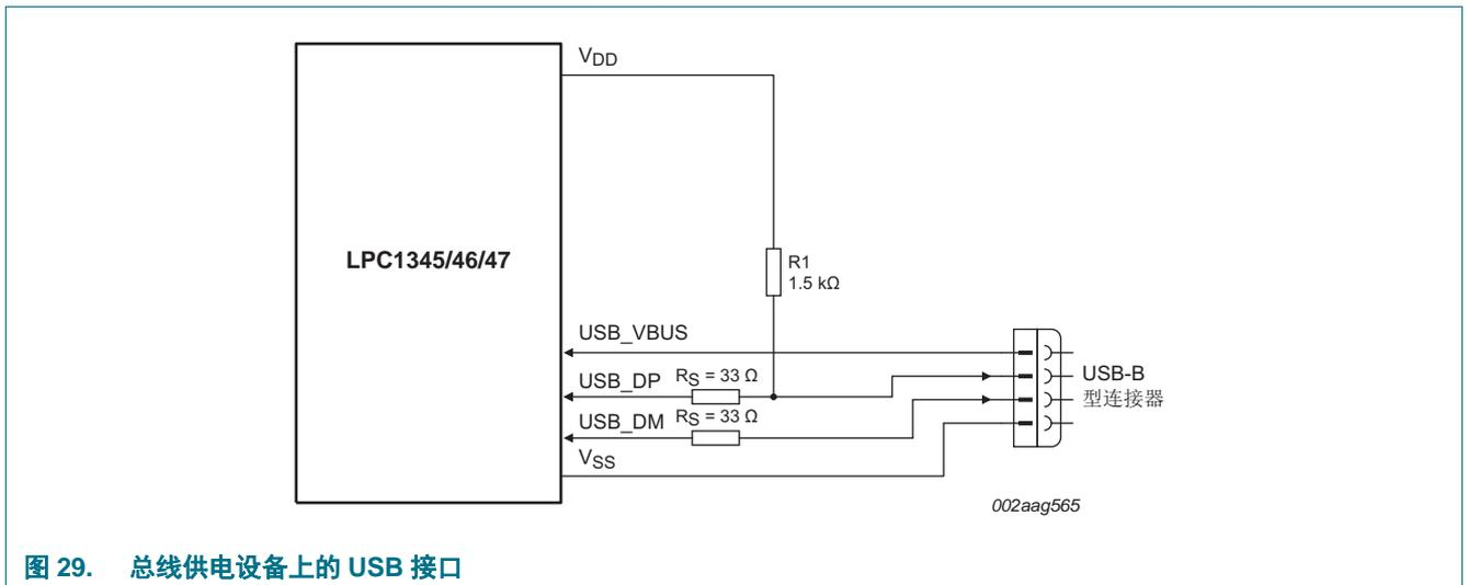
图 29. 总线供电设备上的 USB 接口
