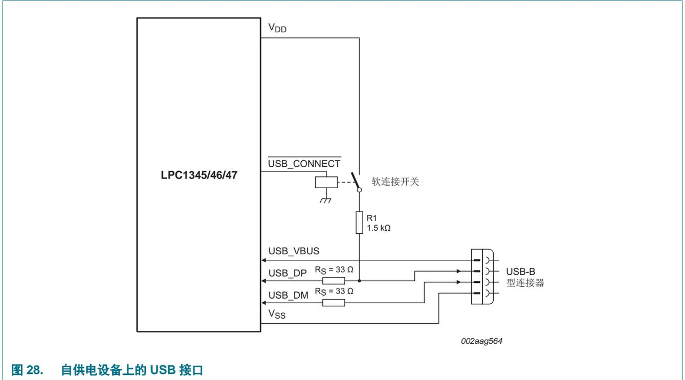
图 28. 自供电设备上的 USB 接口
