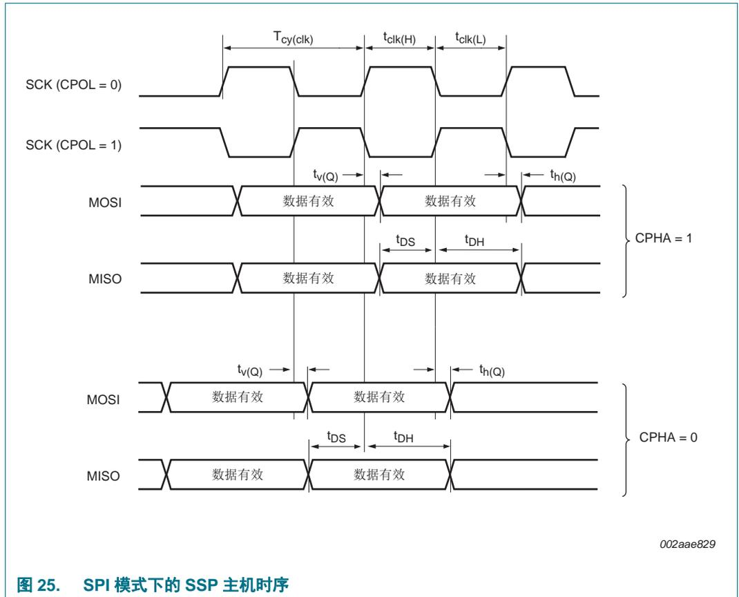
图 25. SPI 模式下的 SSP 主机时序
