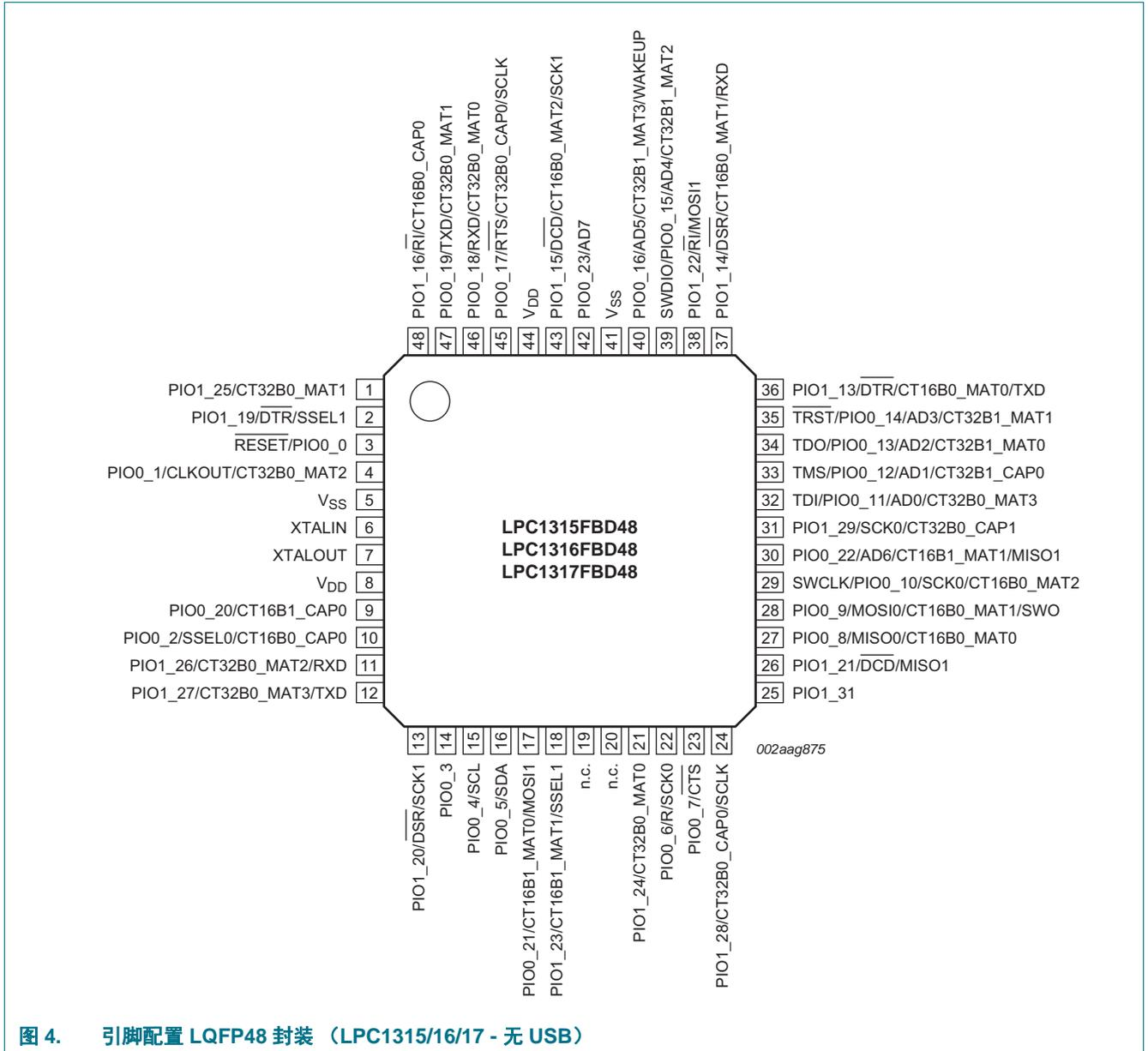
图 4. 引脚配置 LQFP48 封装 (LPC1315/16/17 - 无 USB)
