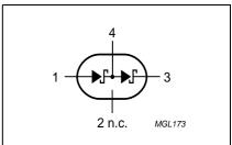
Fig.4 BAT160S diode configuration (symbol).
