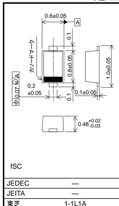
**参考ランド寸法** 単位: mm
