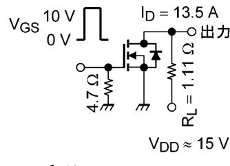
図 6.2.1 スイッチング時間の測定回路例
