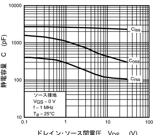
図 8.8 静電容量 -  $V_{DS}$
