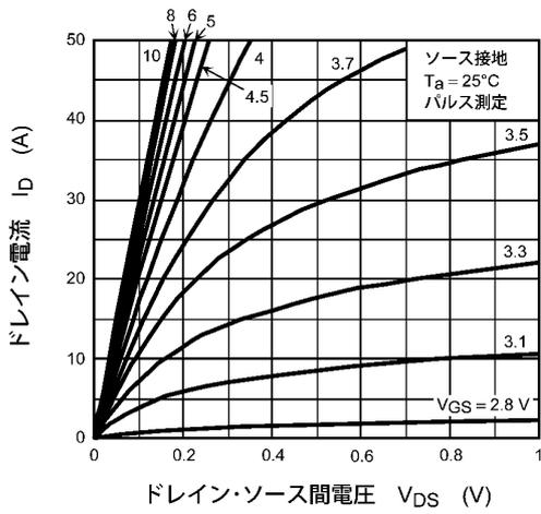
図 8.1  $I_D - V_{DS}$
