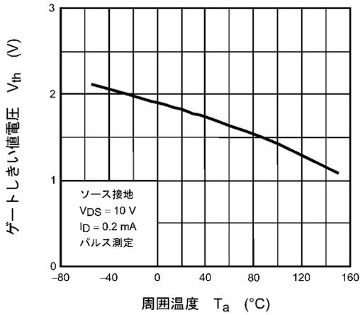
図 8.9  $V_{th} - T_a$
