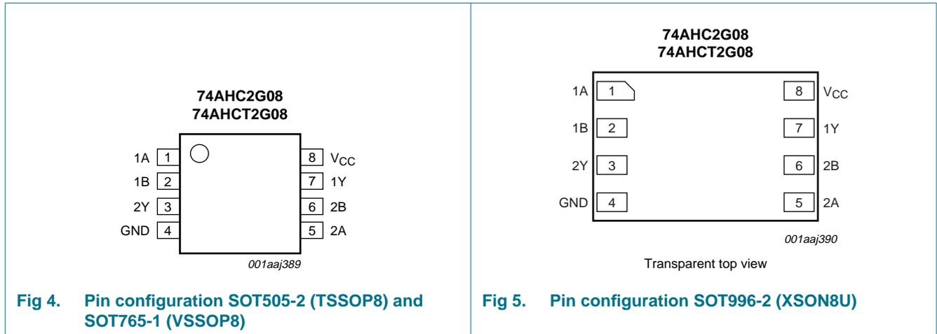
**Fig 4. Pin configuration SOT505-2 (TSSOP8) and SOT765-1 (VSSOP8)**
