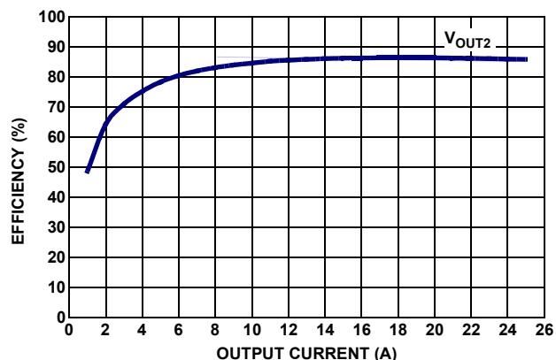
FIGURE 12. CHANNEL 2 EFFICIENCY (12V  $V_{IN}$  AND 1.2V  $V_{OUT}$ )
