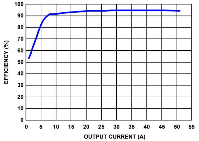
FIGURE 14. EFFICIENCY (12V  $V_{IN}$  AND 3.3V  $V_{OUT}$ )
