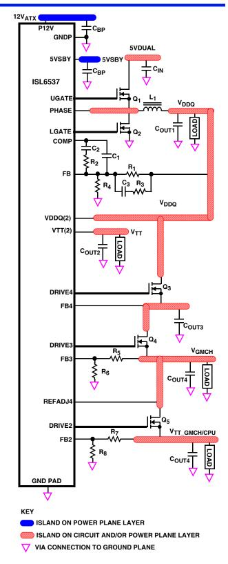
FIGURE 2. PRINTED CIRCUIT BOARD POWER PLANES
