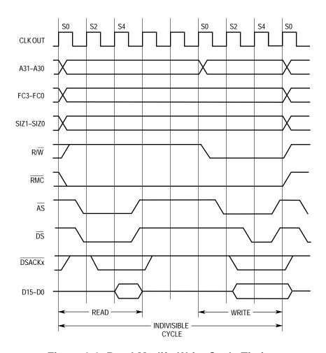
Figure 3-9. Read-Modify-Write Cycle Timing
