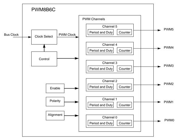
Figure 12-1. PWM8B6CV1 Block Diagram
