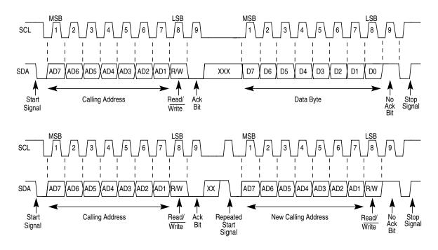
Figure 10-9. IIC-Bus Transmission Signals
