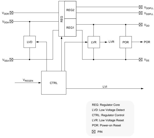
Figure 14-1. VREG3V3 Block Diagram
