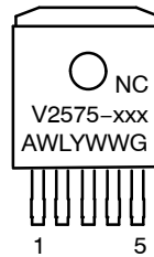
D 2 PAK D2T SUFFIX CASE 936A
