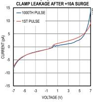
100ns TRANSMISSION LINE PULSER TEST CLAMP CURRENT vs. VOLTAGE & LEAKAGE LEAKAGE CURRENT AFTER EACH PULSE (pA)
