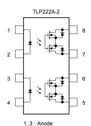
2, 4 : Cathode 5 : Drain D1 6 : Drain D2 7 : Drain D3 8 : Drain D4
