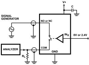
FIGURE 4. OFF ISOLATION TEST CIRCUIT
