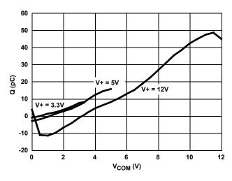
FIGURE 12. CHARGE INJECTION vs SWITCH VOLTAGE
