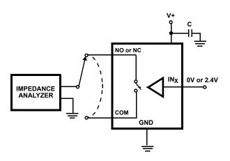
FIGURE 7. CAPACITANCE TEST CIRCUIT
