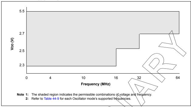
FIGURE 44-2: VOLTAGE FREQUENCY GRAPH, -40°C <- +125°C, PIC18LF26/27/45/46/47/55/56/57K42 ONLY
