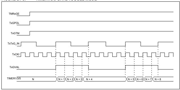
FIGURE 21-6: TIMER1/3/5 GATE SINGLE-PULSE MODE
