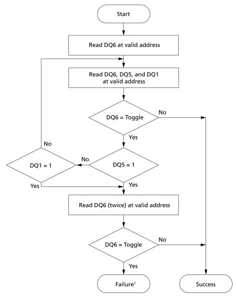
Notes: 1. Failure results: DQ5 = 1 indicates an operation error; DQ1 = 1 indicates a WRITE TO BUFFER PROGRAM ABORT operation.
